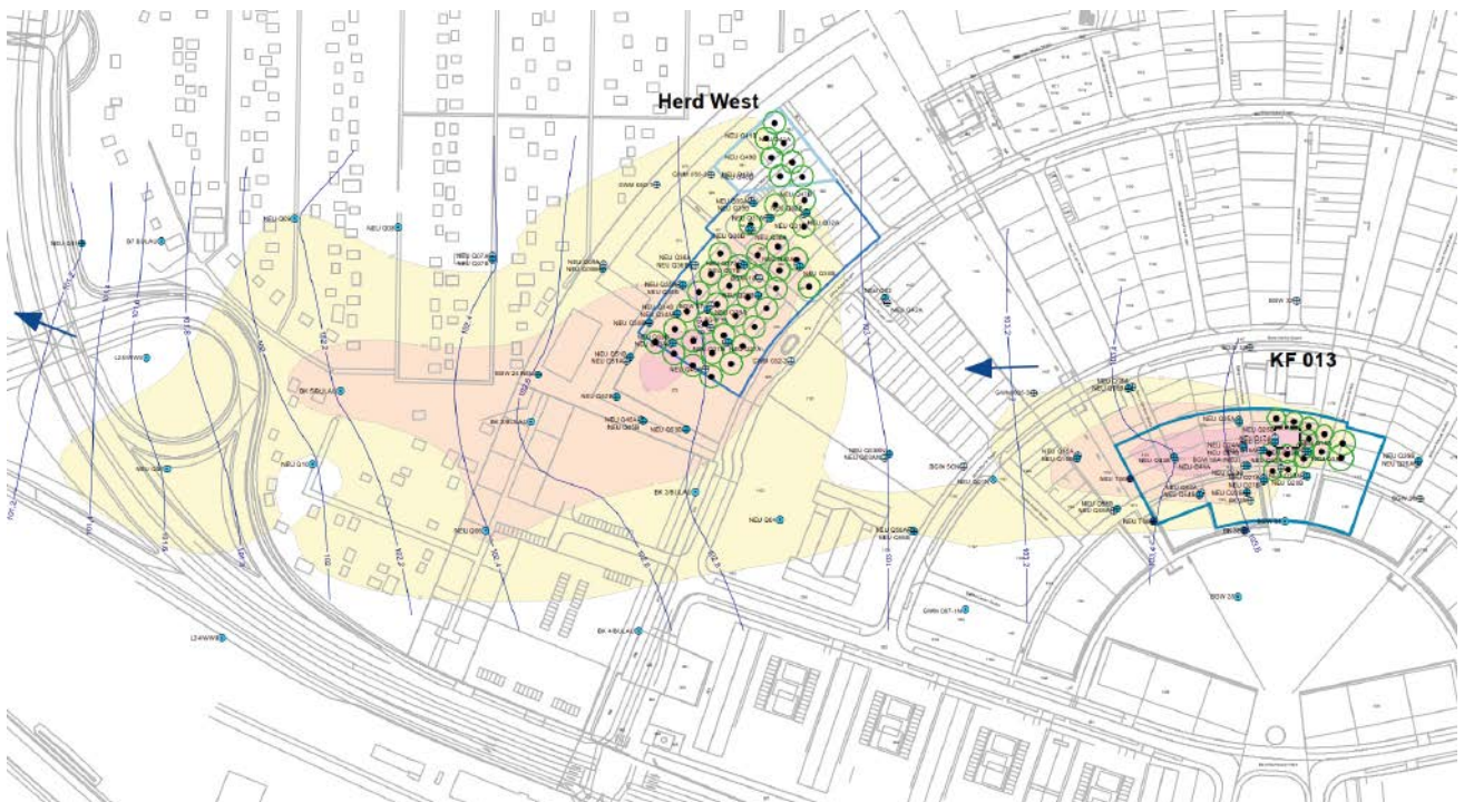
Abbildung 1: Standortplan mit Sanierungsbereichen, Vorhalteflächen und LCKW-Fahne
