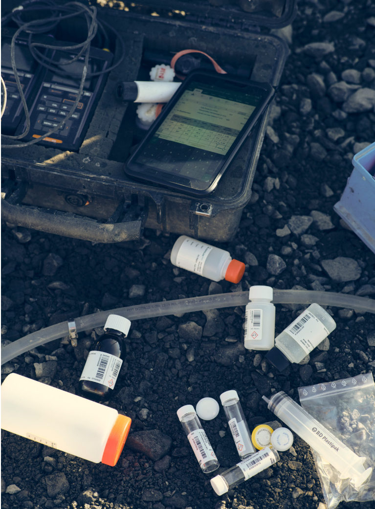
Regelmäßig werden im Pioneer Park Wasserproben entnommen, um den Fortschritt bei der Sanierung zu dokumentieren
