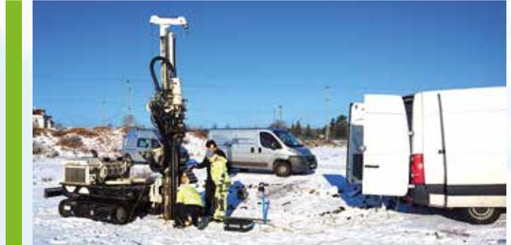
Mit diesen Verfahren können während des Sondiervorgangs In-situ-Daten über die geologischen und hydraulischen Eigenschaften des Untergrundes sowie die Verteilung organischer Schadstoffe erhoben werden.
