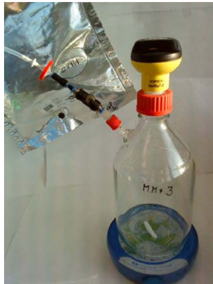
Abb. 5: Versuchsaufbau der Batch-Versuche zum biologischen Schadstoffabbau unter methanotropen Bedingungen
